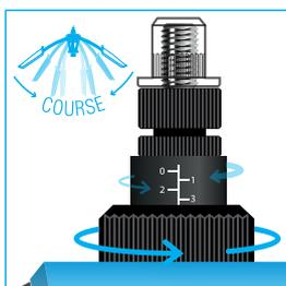
4 - Desserrez la bague **4** puis agir sur le sélecteur **5** afin de régler la course des bras **3** nécessaire au bon sertissage de l'insert. Refermez les bras jusqu'en butée pour sertir.
